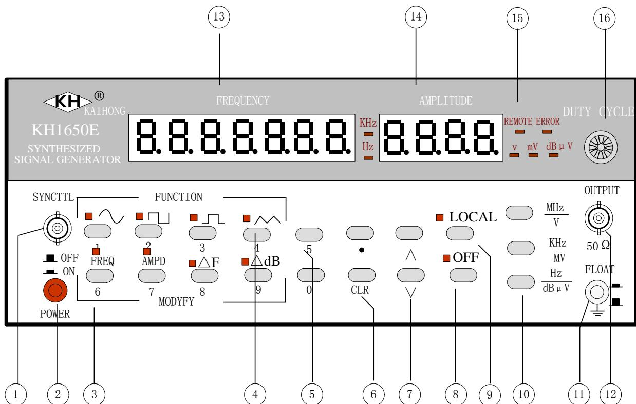
(1) **SYNC TTL** .....BNC 接口，同步 TTL 脉冲或方波输出端口。
