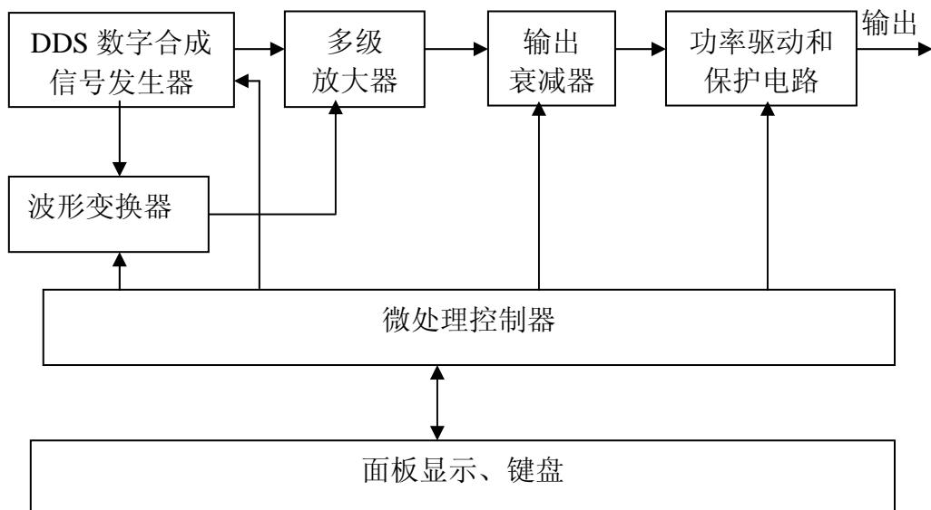
KH1650E 型信号发生器主要由 DDS 数字合成信号发生器、波形变换器、多级放大器、输出衰减器、输出功率驱动器及保护电路、微控制器和键盘扫描、液晶数据显示及电源部分组成。
