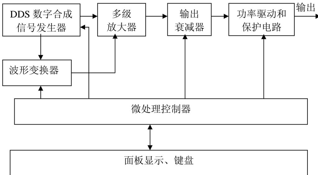
KH1653E 型信号发生器主要由 DDS 数字合成信号发生器、波形变换器、多级放大器、输出衰减器、输出功率驱动器及保护电路、微控制器和键盘扫描、液晶数据显示及电源部分组成。
