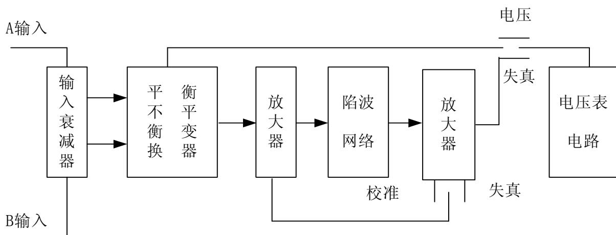
设计中对关键电路和器件采用了特殊的设计和制造工艺，并采用了当代计算机技术与之相结合，程控自动跟踪和 LED 数字显示。本仪器增设了频率计数功能，可使被测信号的频率直接由 LED 精确显示出来，这是老式仪器所不具备的。仪器面板上保留了示波器输出监视插孔，便于使用者直接观察被测信号的波形，特别在失真测量状态，使用者可直接观察到被测信号的失真主要是由哪次谐波形成的及滤谐状态，在小失真信号测量时，可以直接观察到整机的滤谐状态。
